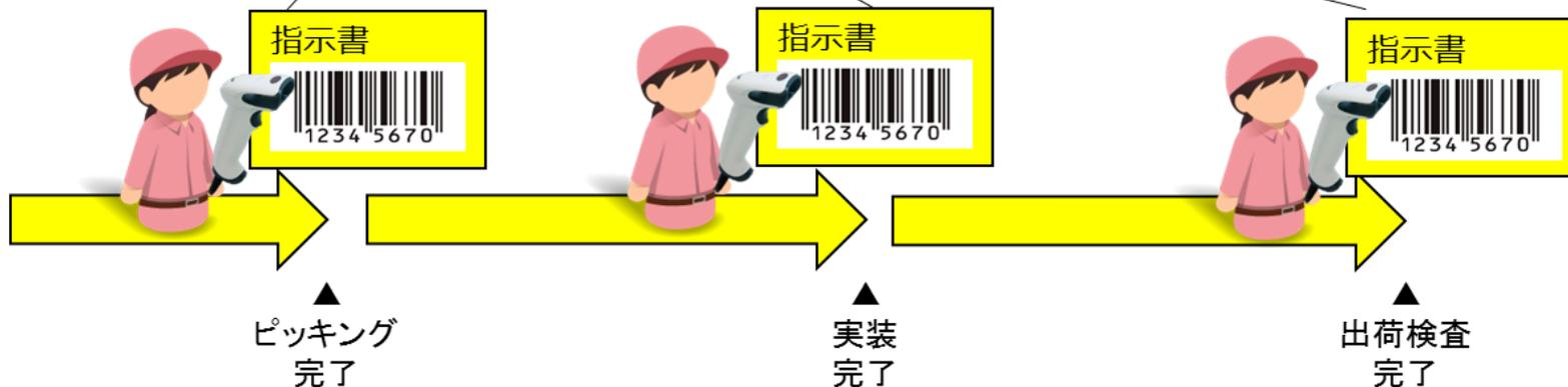
各生産工程において作業が完了した際に指示書のIDを読み込み、工程進捗情報に格納する。格納されたデータは共有工程情報として加工され、お客様と共有する。
