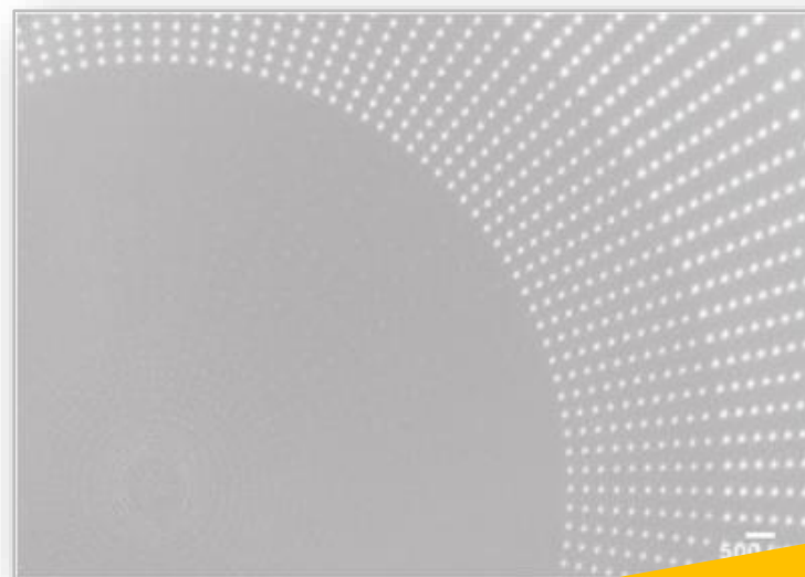
高密度実装やLサイズ基板 穴数: 10,000~50,000穴 穴径: 0.2mm以下
